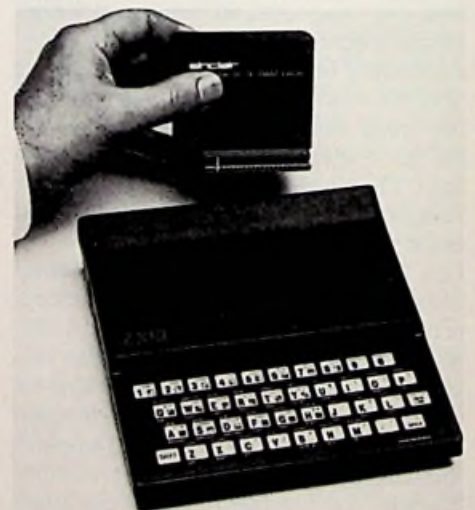
Bild 1. Alle Daten-, Adreß- und Steuerkontakte des Mikroprozessors Z-80-A sind an der Geräterückseite herausgeführt zum Anschluß eines 16-Kbyte RAM-Erweiterungsmoduls
